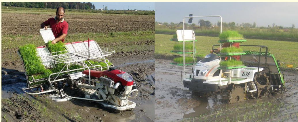
شکل ۱- نشاکار سوارشونده ۶ ردیفه برنج مدل 2ZGF-6 و نشاکار راه‌رونده ۶ ردیفه برنج مدل 2ZS-6
