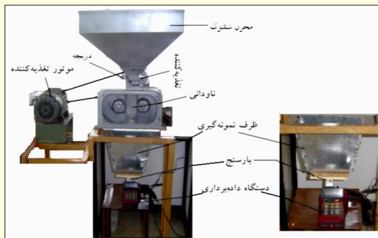
شکل ۳: دستگاه اندازه‌گیری آهنگ و ضریب تغییرات ریزش شلتوک از مخزن پوست‌کن
