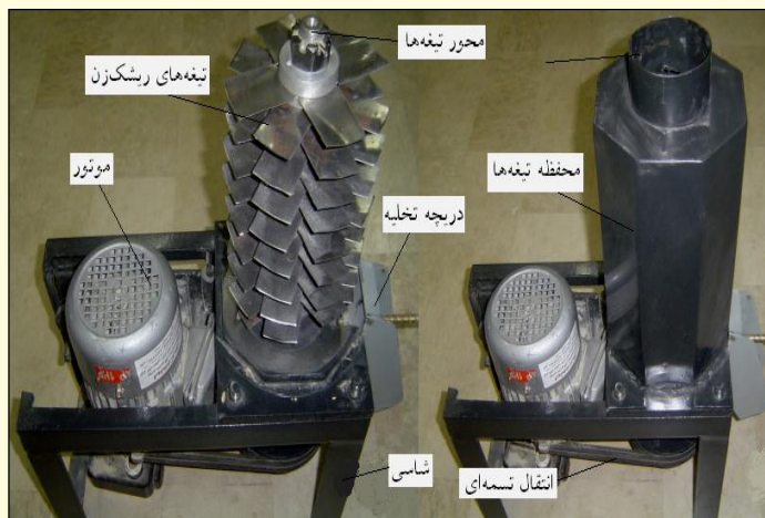
شکل ۲: قسمت‌های مختلف ماشین ریشک‌زن شلتوک
